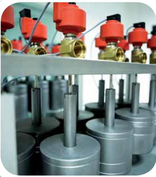
Les valves E<sup>V</sup> CAREL sont testées avec des essais de durée de vie dans les conditions de fonctionnement les **plus critiques** dans les laboratoires CAREL.
