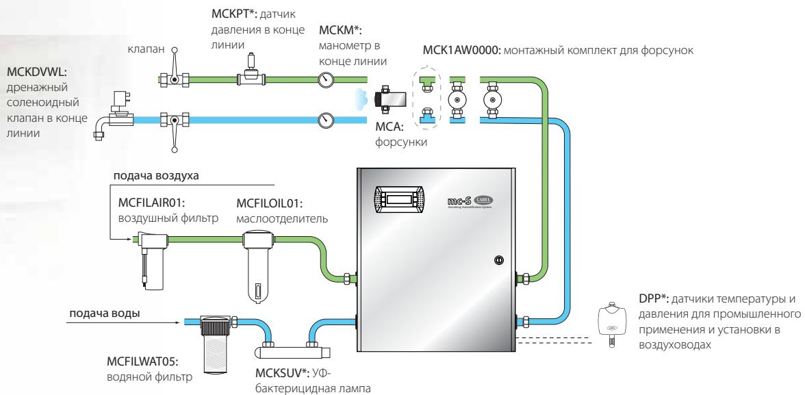
Для упрощения установки и пусконаладки увлажнителя mc multizone поставляются новые аксессуары.
