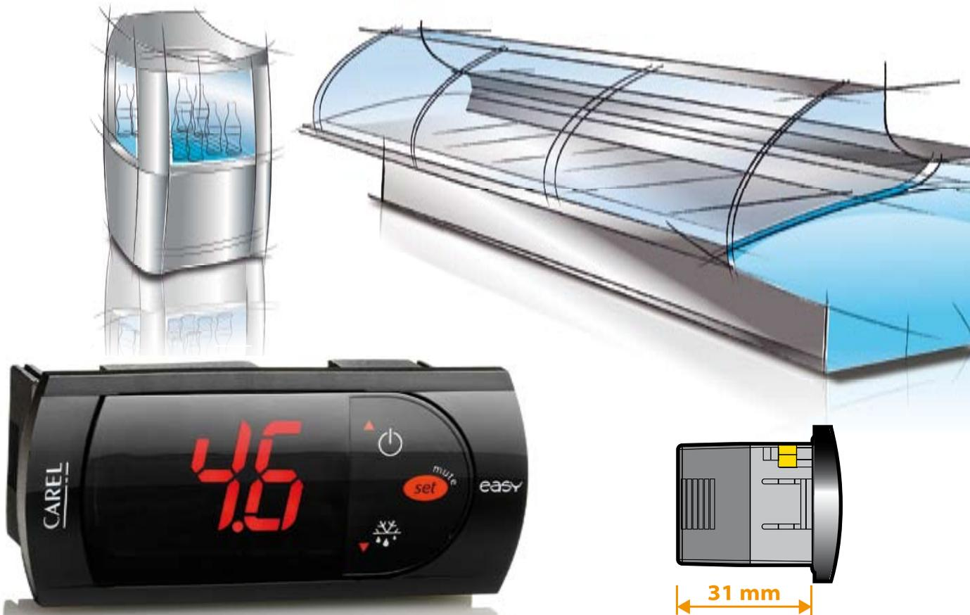
**easy compact** est la solution idéale lorsque l'espace disponible pour installer l'appareil est particulièrement réduit: il n'occupe en effet que 31 mm de profondeur, tout en offrant des sorties relais 2 Hp (2 chevaux) pour le pilotage des compresseurs frigorifiques, sans contacteur.
