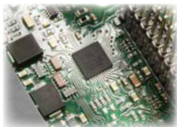
Carel ha sviluppato un chip proprietario impiegando la tecnologia ASIC (Application-Specific Integrated Circuit), che permette una maggiore flessibilità del sistema perché consente ai costruttori di utilizzare la stessa taglia per applicazioni diverse.
