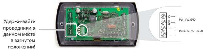
7. В завершение работы закрепите pGD на тыльной части корпуса, удерживая проводники загнутыми только с правой стороны (вид спереди)
