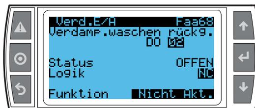
Der digitale Ausgang wird von den Geräten (Verdampfern) Dritter verwendet, um die Sollwertkompensation des Steuerkastens zu aktivieren: zum Beispiel von 5 °C auf -50 °C. Diese Aktion öffnet das Expansionsventil. Die Überhitzungsregelung bleibt gleichzeitig aktiv, um den Kältemittelrückfluss in der Saugleitung zu verhindern. Die Anzahl der Washing-Vorgänge wird im folgenden Fenster eingestellt.
