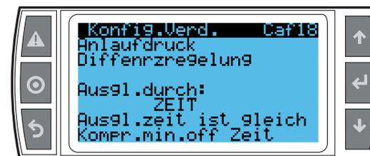
Im Falle des Ausgleichs mittels Druckdifferenz berechnet das Steuergerät das Druckdelta zwischen Saugseite und Druckseite des Verdichters. Liegt die Druckdifferenz unterhalb des im Fenster Cag49 eingestellten Wertes, ist der Verdichter start-bereit.
