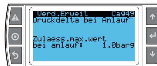
Im Falle des zeitgesteuerten Ausgleichs berechnet das Steuergerät nicht die Druckdifferenz, sondern kann nach einer festen Ausgleichszeit gleich der Mindest-AUS-Zeit des Verdichters (einstellbar im Fenster Caf35) starten.
