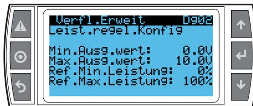
**Beispiel 1:** Mindestwert des Regelausganges: 0 V, Höchstwert des Regelausganges: 10 V, Mindestleistung der Regelvorrichtung: 0 %, Höchstleistung der Regelvorrichtung: 100 %.
