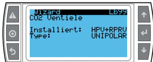
**Fenster Lb3a:** Ende des assistierten Verfahrens. Mit der ENTER-Taste wird das Verfahren beendet und startet die Systemkonfiguration mit Übernahme der Einstellungen.
