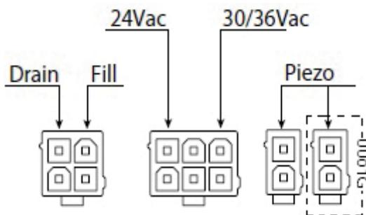
1. Conectar el cable de alimentación de los piezoeléctricos
