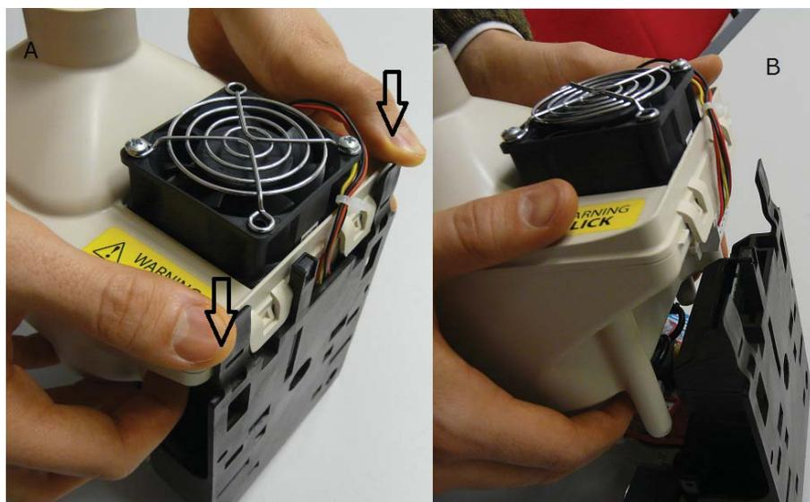
**Nota:** Antes de proceder con la instalación, retire el tanque de la base, empujando las aletas negras como se muestra.
