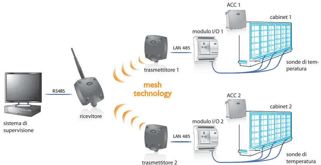
Globalmente l'installazione è di basso impatto (cablaggi ridotti sfruttando la tecnologia wireless mantenendo la regolazione già installata a bordo delle utenze frigorifere).
