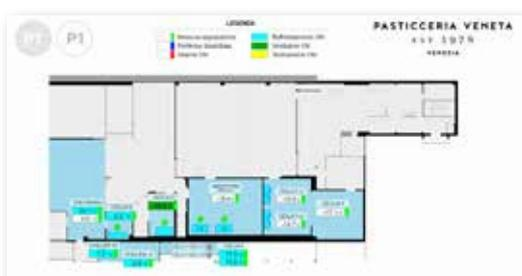
Fig. 1.e - Mappa del sito per il monitoraggio dello stato degli allarmi
