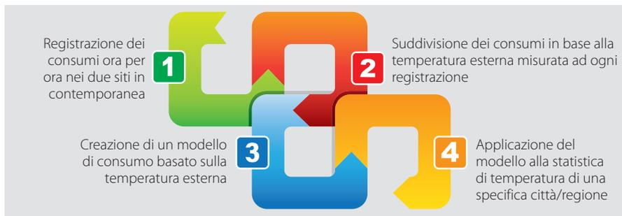
A partire dai consumi orari registrati grazie al supervisore Boss, è stato ricavato un modello che lega il consumo previsto con la temperatura esterna. Le curve risultanti evidenziano il vantaggio del sistema waterloop di CAREL per le temperature più frequenti nella nostra zona climatica.
