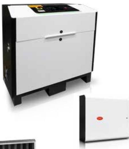
humiFog è un sistema di umidificazione adiabatica a nebulizzazione, basato su una pompa volumetrica ad alta pressione ed un sistema di distribuzione con speciali ugelli nebulizzatori per un veloce assorbimento nell'aria. La stazione pompante, disponibile con capacità fino a 1350 l/h e fornita di inverter per la massima efficienza energetica, fornisce acqua ad una pressione fino a 70 bar, per una finissima nebulizzazione (diametro medio delle gocce: 10-15 micron).
