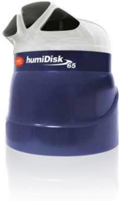
humiDisk是一种小而耐用的加湿器，它使用涡流盘将水雾化并转化成无数的小液滴，这些小水滴被内置风机吹送并导入环境中，在环境中蒸发、加湿及冷却空气。适用于小冷库，用于产品保存，像食品和蔬菜；小店和工业环境。
