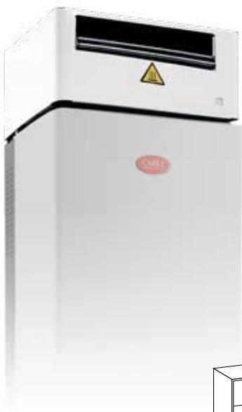
Les **têtes de ventilation** peuvent être **installées directement sur l'humidificateur** ou à distance. Dans le deuxième cas, un support et un tube vapeur sont fournis pour raccorder la tête de ventilation. La tête de ventilation fonctionne en mode ON/OFF et est contrôlée par un dispositif thermique qui la met en marche lorsque de la vapeur se dégage.
