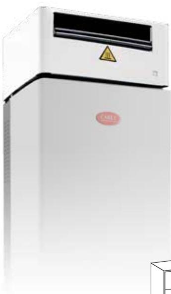
Los **cabezales ventiladores** se pueden **instalar directamente en el humidificador o a distancia**. En el segundo caso, se suministra un soporte y un tubo de vapor para conectar el cabezal al humidificador. El cabezal ventilador funciona en modo todo-nada y es controlado por un dispositivo térmico que lo activa cuando se produce vapor.
