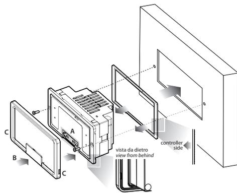
Coppia di serraggio / tightening torque: 0,4 N/m
