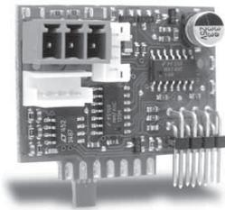
**Fig. 1.f****Analogue output module (code CONV0/10A0)**
